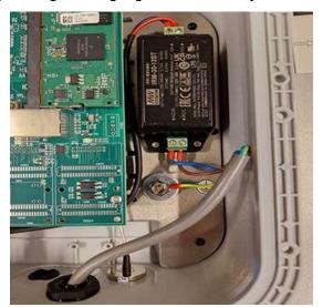
Sobald die Spannungsversorgung angeschlossen ist, schließen Sie den Deckel des Gehäuses und ziehen Sie die Schrauben handfest an.
