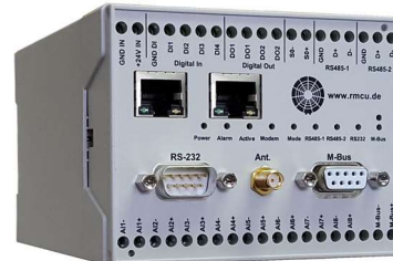
2x Ethernet-Schnittstelle für IT/OT Trennung
